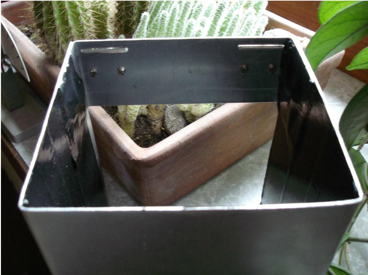
Und so sehen die Winkel von der anderen Seite aus. Man sieht die M3-Gewindelöcher. Vorn sind die Winkel durch die Schlitz in 1 mm dicken Alublech gesteckt.
