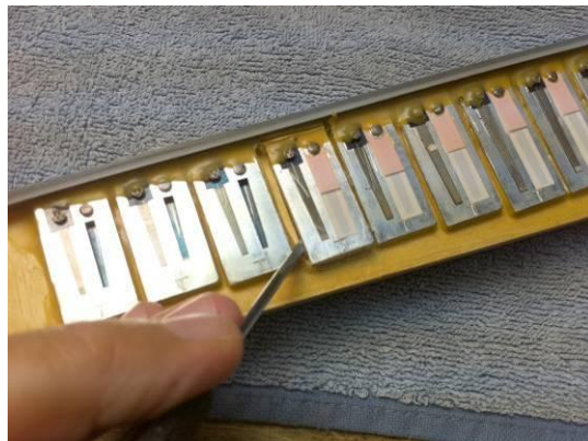
Abbildung 20: links: Wachs anritzen; rechts: Stimmplatte heraushebeln
