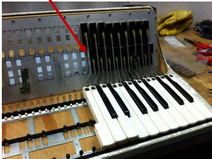
Abbildung 13: links: Pianotasten einsetzen; rechts: Tastaturfedern und Kunststoffclipse
