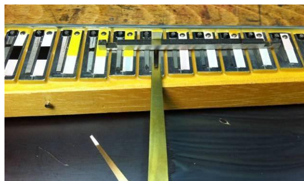
Abbildung 61: Stimmplättchen unter eine Stimmzunge untergeschoben
