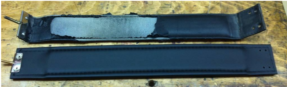
Abbildung 82: oben der alte, unten der neue Handzug
