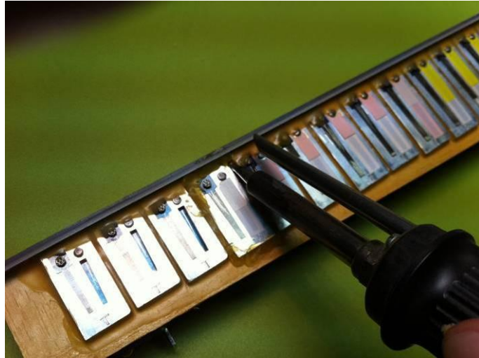
Abbildung 44: Einschmelzen des Stimmwachses mit LötKolben
