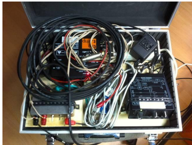
Abbildung 36: mein Messkoffer mit Mic-Preamp, Endstufe, Umschaltbox zur Lautsprechermessung
