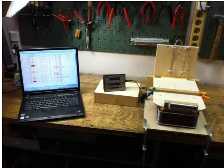
Abbildung 84: Aufbau meiner Stimmstation (Laptop, Stimmgerät, Stimmbalg)
