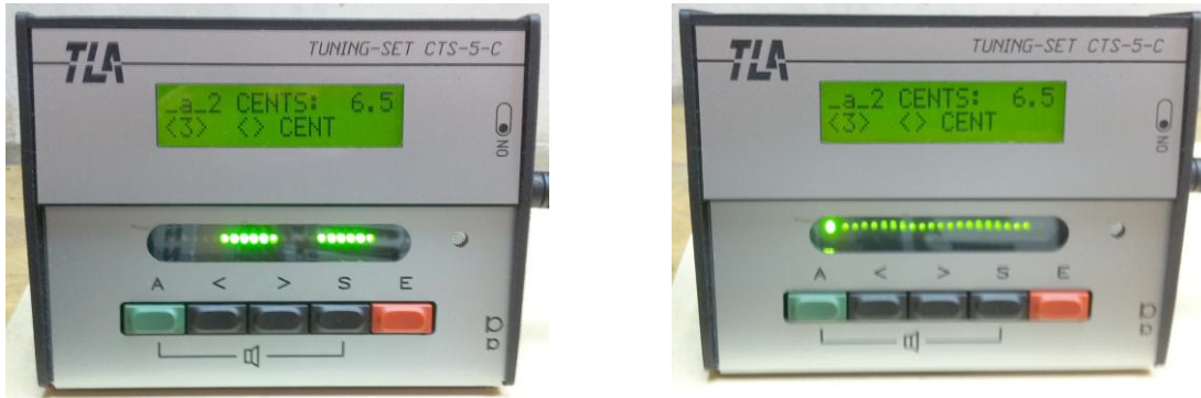
Abbildung 58: Stroboskopanzeige "steht" (links) und "läuft durch" (rechts)
