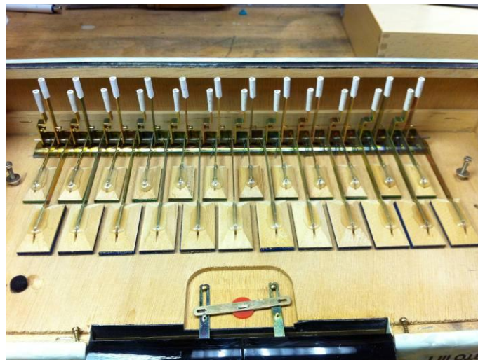
Abbildung 79: Bassklappen (Bassmechanik bereits ausgebaut)
