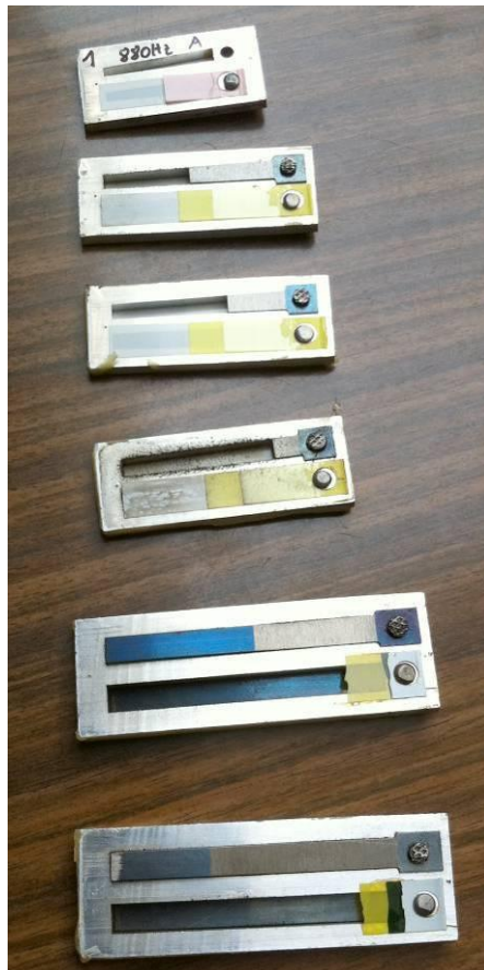
Abbildung 40: sechs defekte Stimmplatten in Christine
