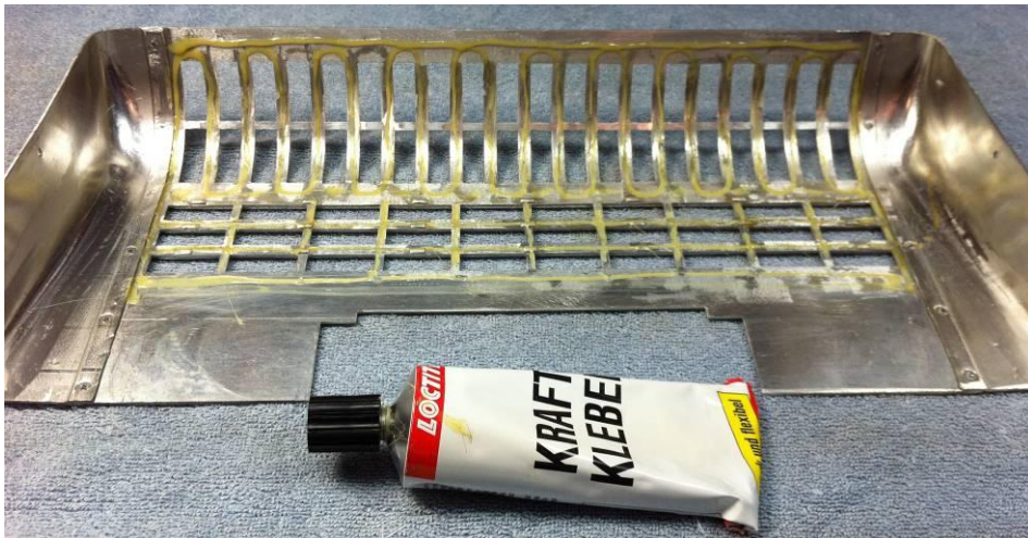
Abbildung 51: Loctite Kraftkleber aufgetragen
