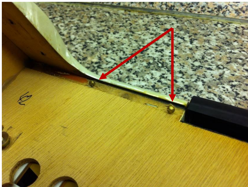
Abbildung 77: schiefe Schraubchen gehen zwar- sind einfach kein "feiner Stil"!
