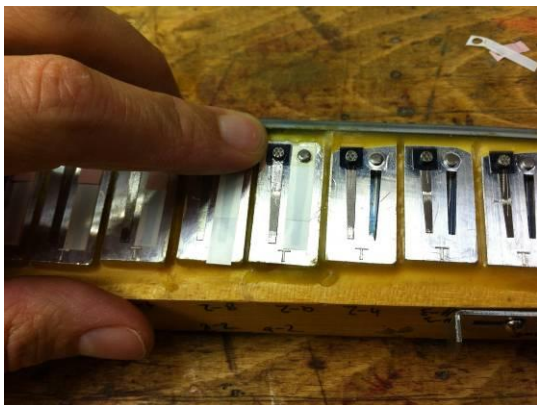
Abbildung 94: Ventil sauber ausrichten, dann in der Länge kürzen - fertig!
