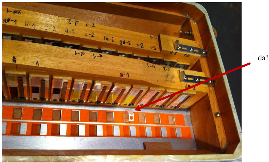
Abbildung 90: ein Ventil eingeklemmt und abgerissen!
