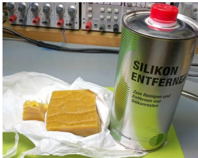
Abbildung 26: ein Klumpen Stimmwachs und sein Gegenspieler (Silikonentferner)
