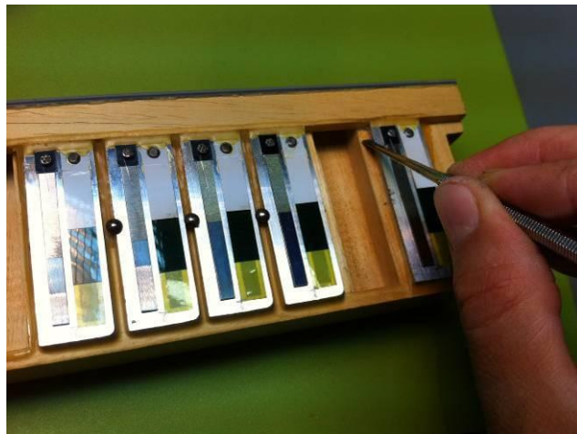
Abbildung 46: die nächste Stimmplatte: Auskratzen der alten Wachsreste
