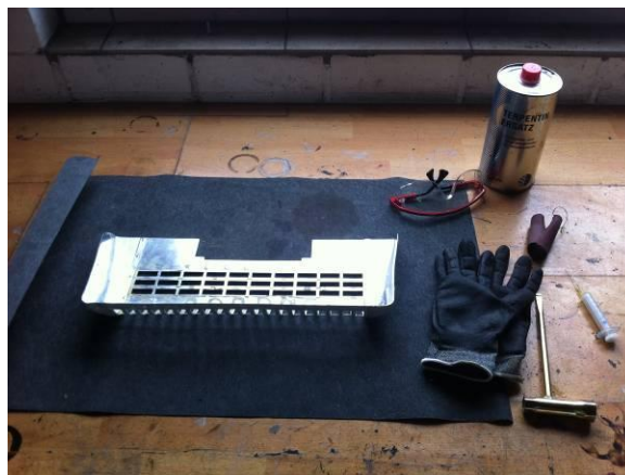
Abbildung 47: Kleberreste entfernen mit Schutzausrüstung
