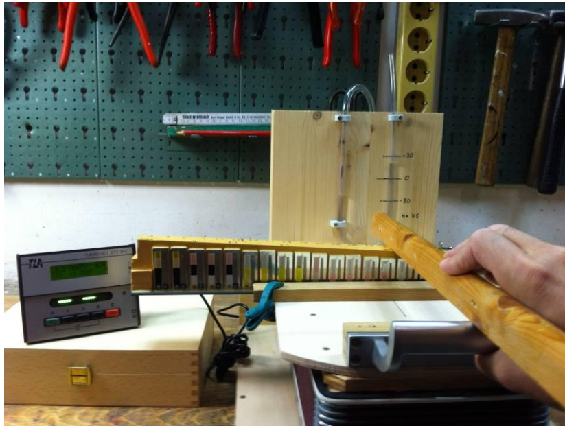
Abbildung 72: Messung am Stimmstock mit Druckkontrolle
