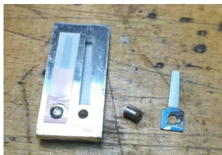
Abbildung 24: Stimmplatte mit entfernter, defekter Stimmzunge
