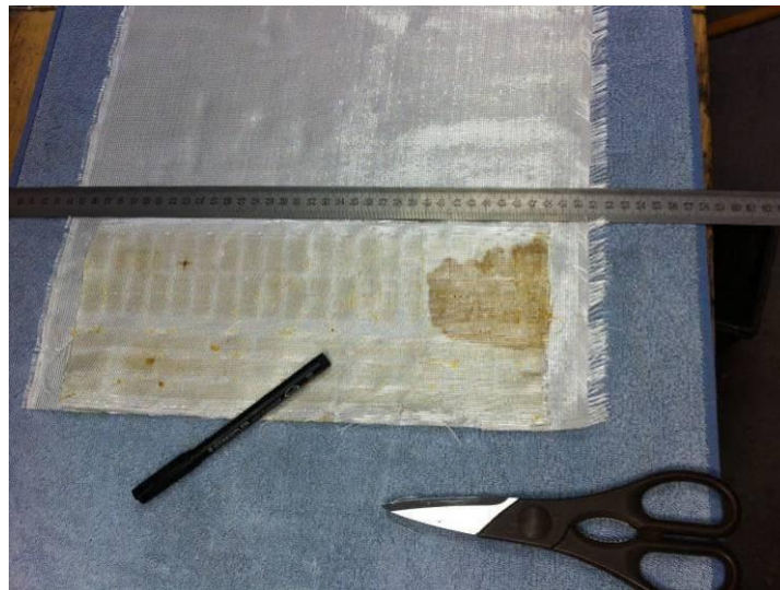
Abbildung 50: neue Gaze beim Zuschnitt (oben: neue Gaze; unten: alte Gaze)
