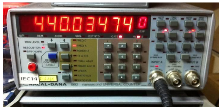
Abbildung 34: gut für Funkgeräte, aber nicht für Akkordeons: Racal-Dana 1992 Frequenzzähler
