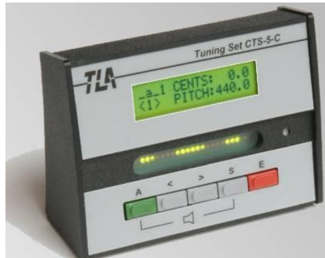
Abbildung 38: Stimmgerät CTS5 von TLA (Quelle: www.tla-electronic.de/ )
