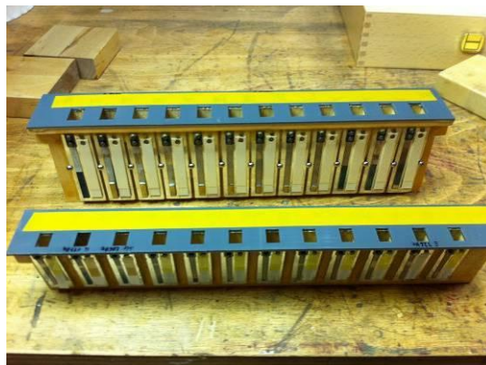
Abbildung 17: zwei Stimmstöcke (jeweils eine Tonreihe abgeklebt)
