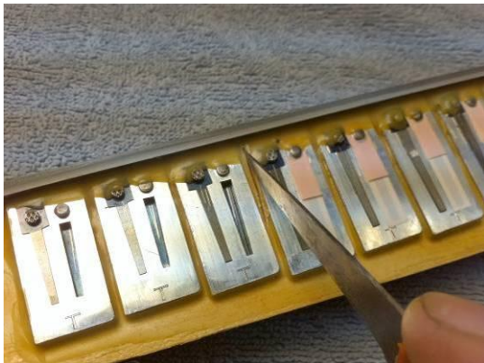
Abbildung 20: links: Wachs anritzen; rechts: Stimmplatte heraushebeln
