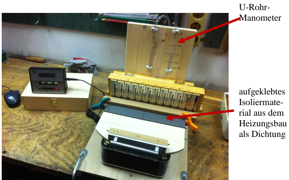
Abbildung 87: Stimmstation im jetzigen Endausbau
