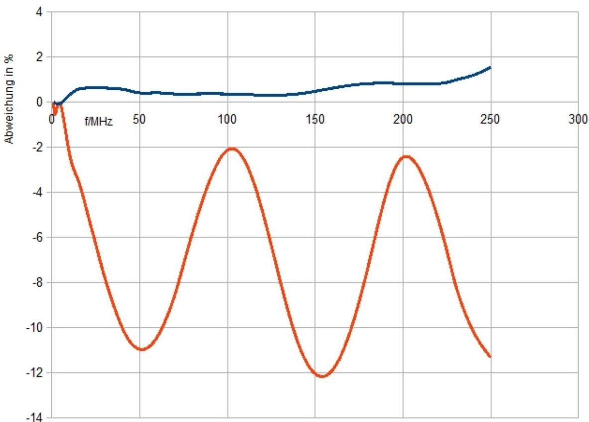
Aufgenommen wurden die Daten mit einem R&S URV5, welches mit einem URY-Z7 Messkopf ausgestattet war, welcher über einen Durchgangswiderstand Typ URY-50 mit dem Kabel verbunden war. Die Messungen gehen von 1MHz bis 250MHz. Der 0% Referenzpunkt wurde bei 1MHz festgelegt.
