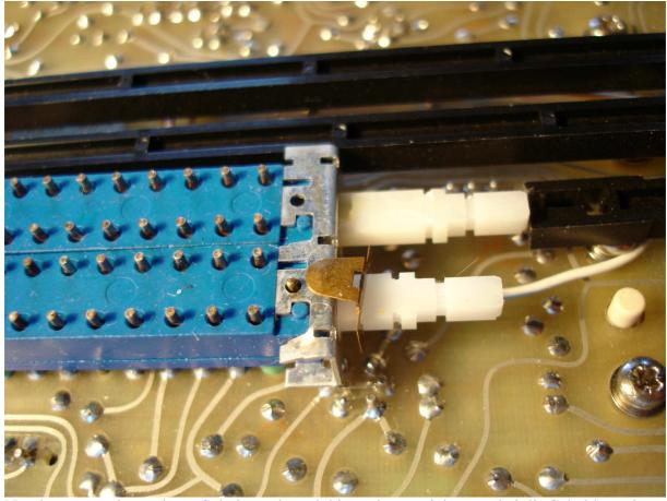
Nun kann man den weissen Schalterstab nach hinten herausziehen, wobei die Schaltkontakte leicht herausspringen
