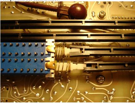
Dann wird die Halteklammer nach oben herausgezogen nach Sichern der Druckfeder
