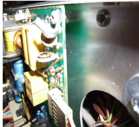
Links (Bildmitte) herausgefräste Schmauchspur an C1504, rechts mit Lack versiegelter Bereich
